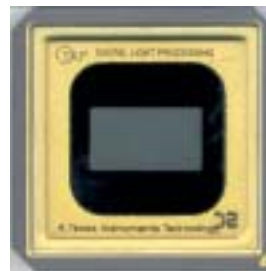
Matrice DMD constituée de miroirs microscopiques.
